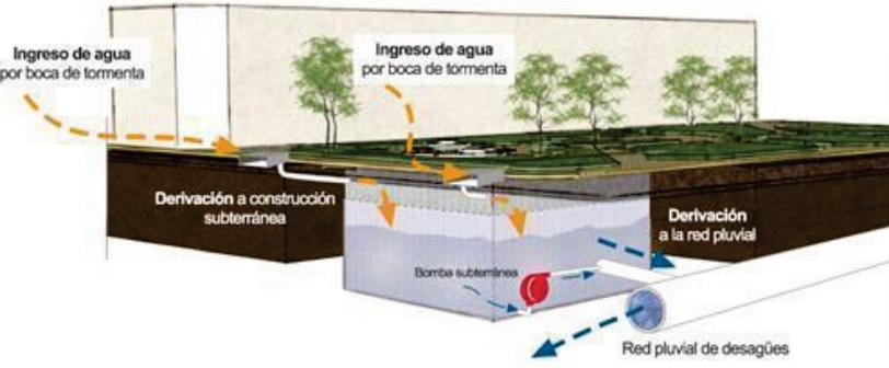
La Plaza del Soldado Argentino cuenta con una construcción subterránea existente y en desuso, factible de adecuarse para ser utilizada como Regulador de Excedentes Pluviales, requiriendo intervenciones relativamente menores para incorporarlo a la Red de Desagües Pluviales existentes, sin comprometer las especies arbóreas, el mobiliario ni el equipamiento urbano.
