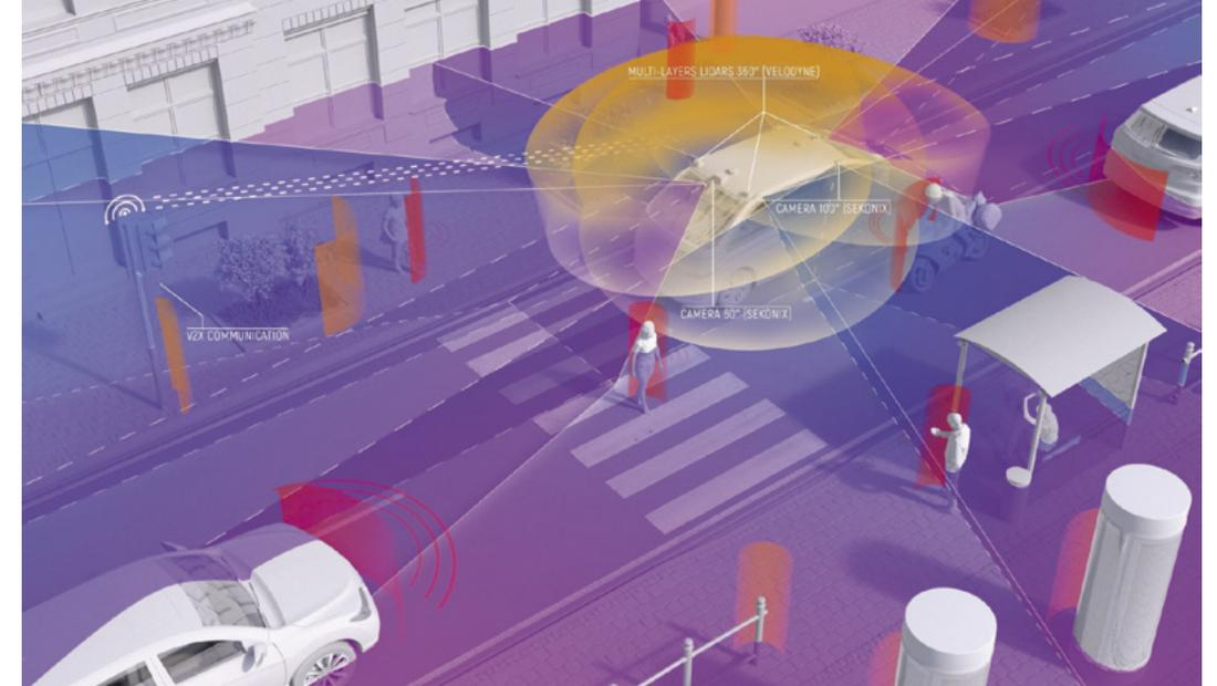
Los vehículos totalmente autónomos usan una combinación de sensores, cámaras, radar e inteligencia artificial para viajar de un punto a otro sin un operador humano. Crédito: Navya
